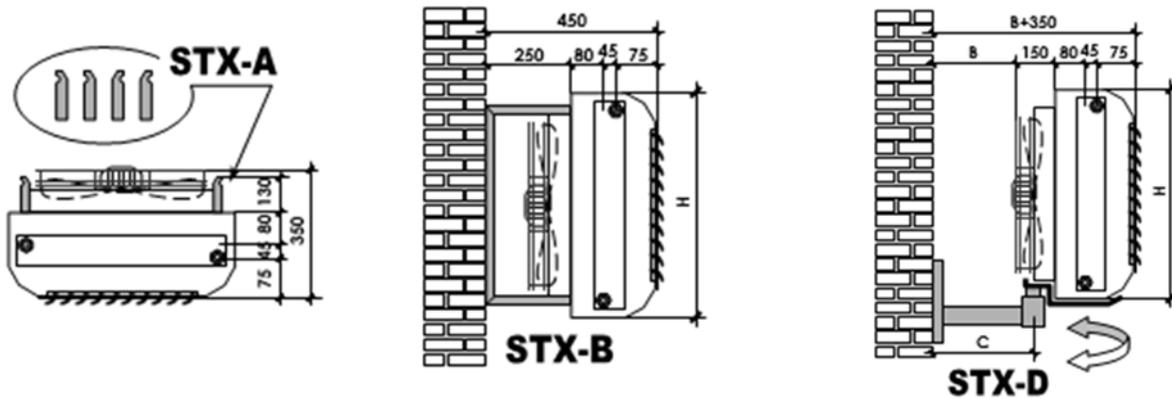
**STX-A:** Soportes de suspensión (4u) para funcionamiento en horizontal
